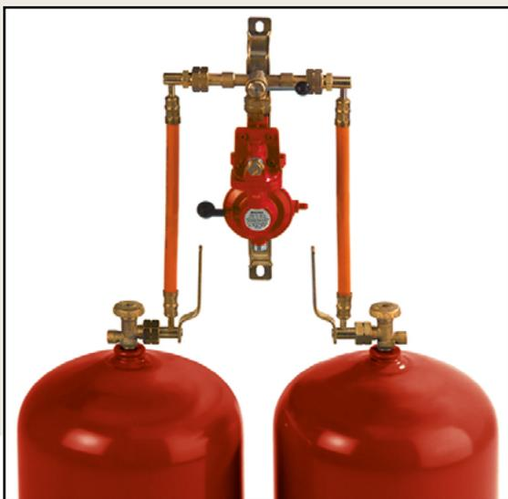
Großflaschenanlagen für 33-kg Flaschen sind nahezu für jeden Verbrauch geeignet. Reicht eine Einflaschenanlage nicht aus, stehen Flaschenbatterien bis 2 x 8 Flaschen zur Verfügung. Dieses Versorgungssystem sieht immer Reserve-Flaschen vor, die über Hand- oder automatische Umschaltung für eine permanente Gaszufuhr sorgen.
